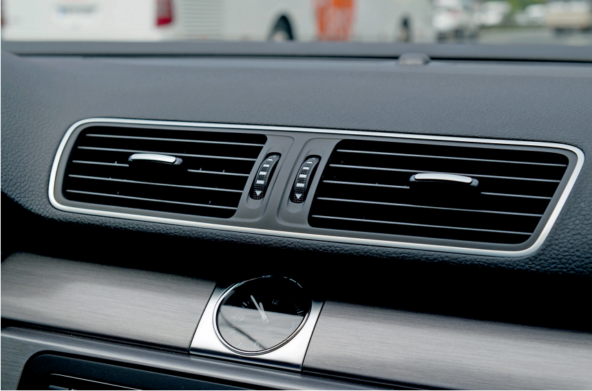
Bild 5. Mit den teilaromatischen PA der Leona-SG-Reihe von Asahi Kasei sind hochwertige Oberflächen ohne spezielle Oberflächenbehandlung umsetzbar. © Asahi Kasei
